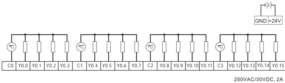
4.7.17 Wiring AH32AN02P-5A
