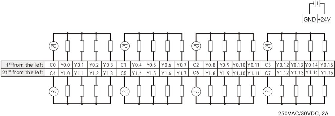
4.7.19 Wiring AH32AN02P-5C
