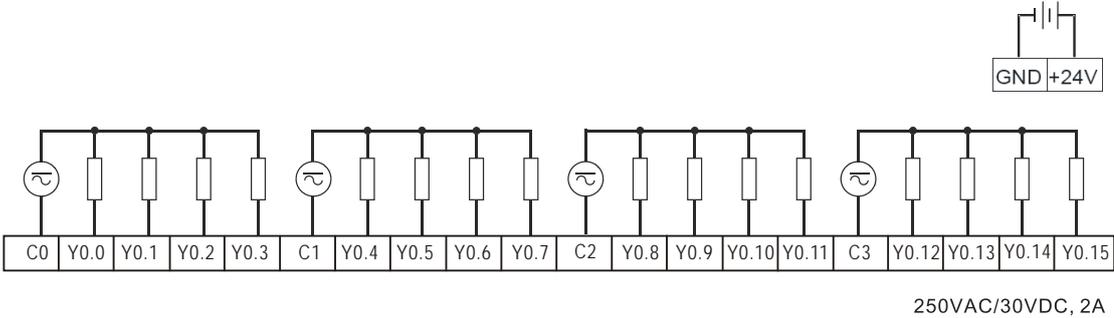
4.7.22 Wiring AH64AN02P-5C
