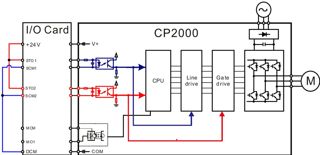
18-3-3 The control loop wiring diagram:
