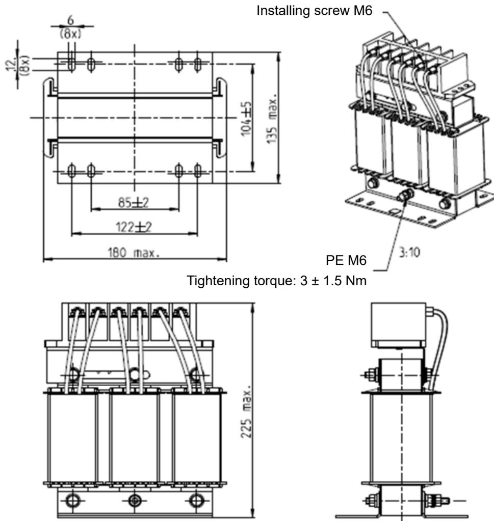
Tightening torque:  $3 \pm 1.5$  Nm
