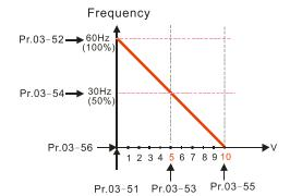
$\begin{array}{l} Pr.03-51=1V\,;\, Pr.03-52=10\,\%\\ Pr.03-53=5V\,;\, Pr.03-54=50\,\%\\ Pr.03-55=10V\,;\, Pr.03-56=100\,\% \end{array}$
