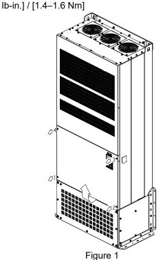
2). Screw torque: 24-26kg-cm / [20.8-22.6 lb-in.] / [2.4-2.5 Nm]
